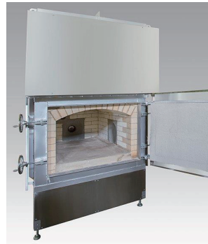
▲（有）京滋エンジニアリングが開発した動物用火葬炉【写真左】。煙や臭いが全く出ず、小型犬なら20分、大型犬でも40分程度という短時間で火葬を行うことができる。愛愛送社では斎場にこの火葬炉を設置しているほか、専用車【写真右】での移動火葬にも対応している
