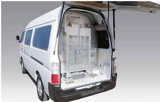
▲（有）京滋エンジニアリングが開発した動物用火葬炉【写真左】。煙や臭いが全く出ず、小型犬なら20分、大型犬でも40分程度という短時間で火葬を行うことができる。愛愛送社では斎場にこの火葬炉を設置しているほか、専用車【写真右】での移動火葬にも対応している
